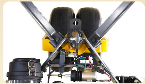
Verrouillez la roue arrière en position « straight ahead » (droit devant) pour aider à créer des bandes droites.
