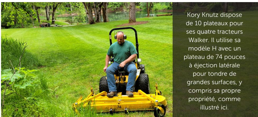
Kory Knutz dispose de 10 plateaux pour ses quatre tracteurs Walker. Il utilise sa modèle H avec un plateau de 74 pouces à éjection latérale pour tondre de grandes surfaces, y compris sa propre propriété, comme illustré ici.
