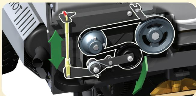
Transfert d'énergie lorsque le GHS n'est pas utilisé
