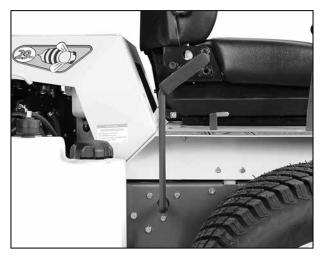
**Blade Clutch Disengaged**
