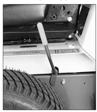
**Parking Brake Disengaged**
