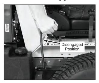
**Blade Clutch Disengaged**
