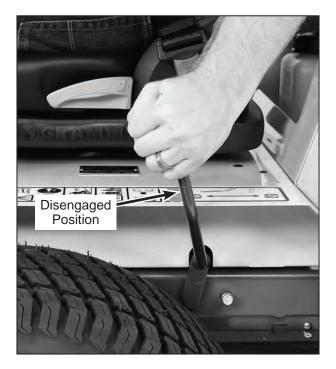
**Parking Brake Disengaged**
