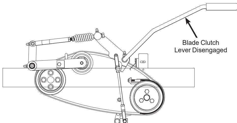
**PTO Clutch Disengaged**
