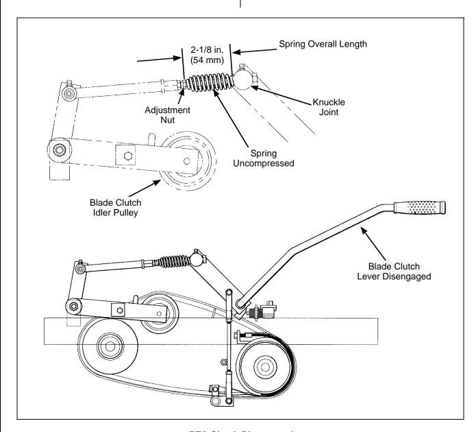
**PTO Clutch Disengaged**
