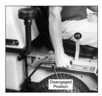
**Blade Clutch Disengaged**
