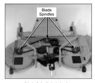
**Blade Spindle Lubrication**
