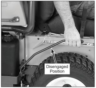
**Blade Clutch Disengaged**
