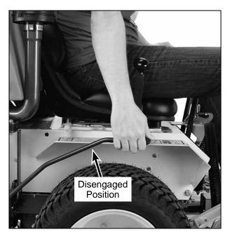
**Blade Clutch Disengaged**
