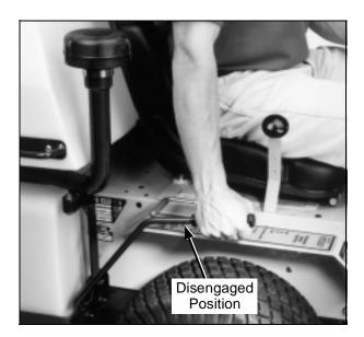
**Blade Clutch Disengaged**
