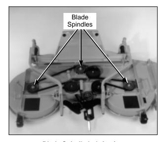
**Blade Spindle Lubrication**
