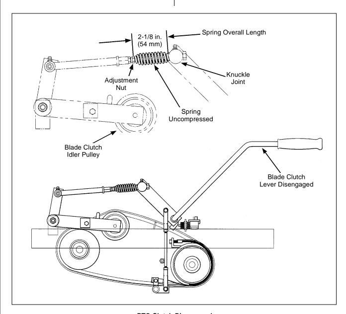
**PTO Clutch Disengaged**
