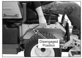
**Blade Clutch Disengaged**
