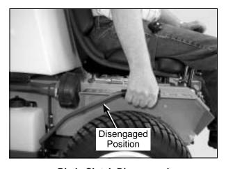
**Blade Clutch Disengaged**
