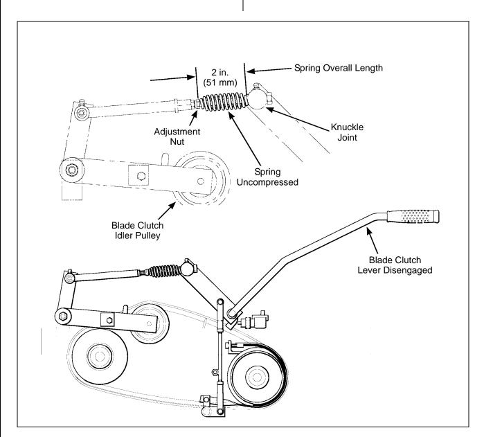
**PTO Clutch Disengaged**
