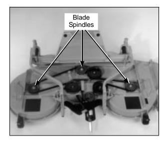
**Blade Spindle Lubrication**
