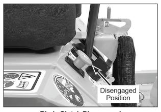
**Blade Clutch Disengaged**
