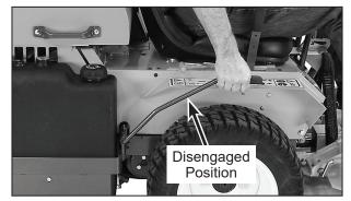
**Blade Clutch Disengaged**
