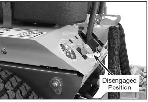
**Blade Clutch Disengaged**
