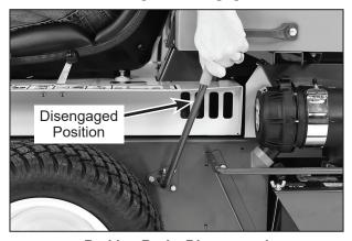
**Parking Brake Disengaged**
