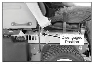
**Blade Clutch Disengaged**
