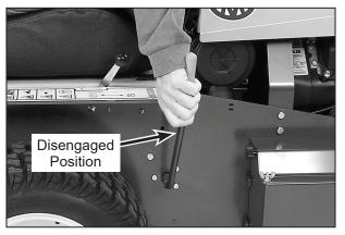
**Parking Brake Disengaged**
