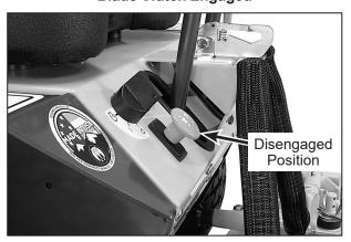
**Blade Clutch Disengaged**
