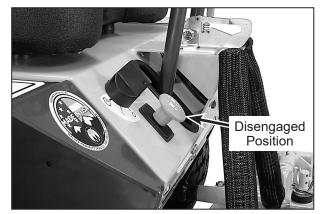
**Blade Clutch Disengaged**
