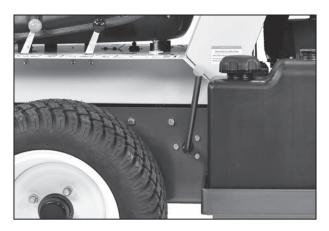
**Parking Brake Disengaged**
