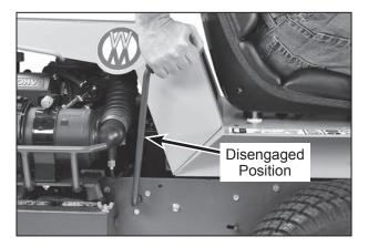
**Blade Clutch Disengaged**
