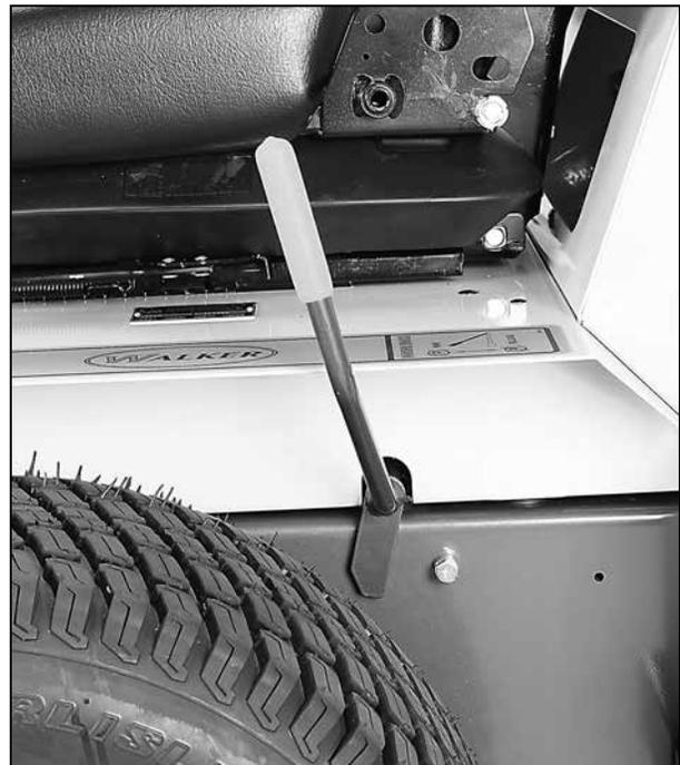
**Parking Brake Disengaged**
