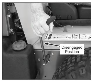
**Blade Clutch Disengaged**
