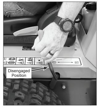
**Parking Brake Disengaged**
