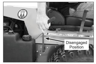
**Blade Clutch Disengaged**
