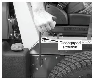
**Blade Clutch Disengaged**
