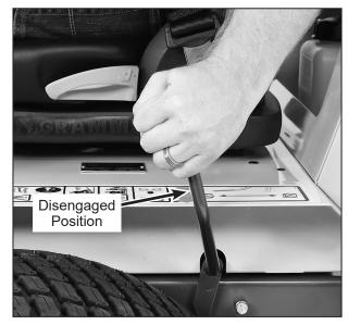
**Parking Brake Disengaged**
