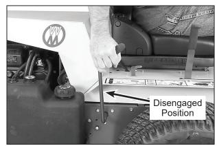
**Blade Clutch Disengaged**
