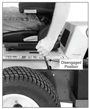
**Parking Brake Disengaged**
