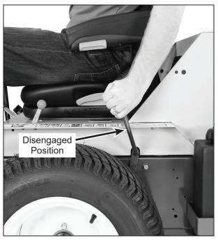
**Parking Brake Disengaged**
