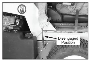
**Blade Clutch Disengaged**
