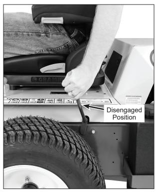
**Parking Brake Disengaged**
