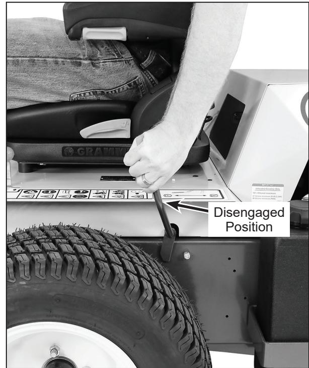
**Parking Brake Disengaged**
