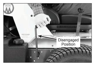
**Blade Clutch Disengaged**
