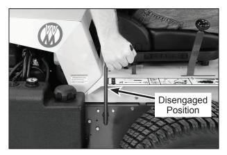
**Blade Clutch Disengaged**
