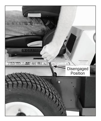
**Parking Brake Disengaged**
