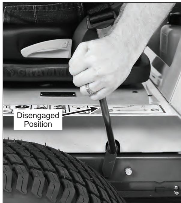
**Parking Brake Disengaged**
